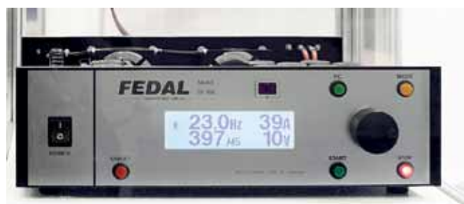
Рис.3. Импульсный источник питания лазера с диодной накачкой SF306, предназначенный для работы в различных лазерных комплексах
