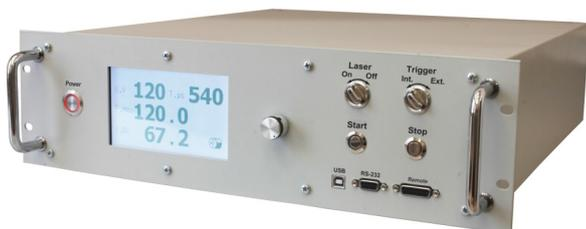
Контроллер управляющий с распределителем синхроимпульсов предназначен для одновременного или отдельного управления несколькими источниками питания лазера. Устройство содержит интерфейс управления источниками и систему генерации импульсов синхронизации. Устройство оснащено удобным интерфейсом управления, графическим ЖК-дисплеем, одним входом и 8ю выходами синхронизации. Может быть подключено к компьютеру по RS232, USB, Ethernet.
